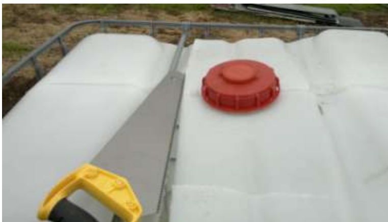
Figura 4.2. Eliminación de la parte superior del tanque.
