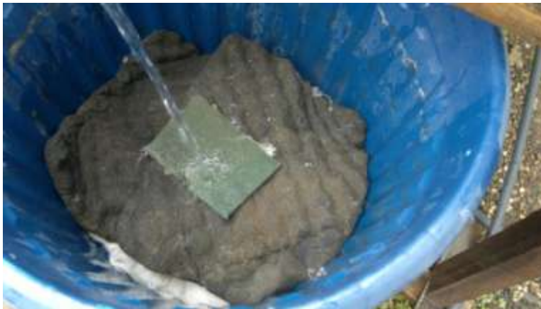
Figura 4.21. El biofiltro con material esponjoso.
